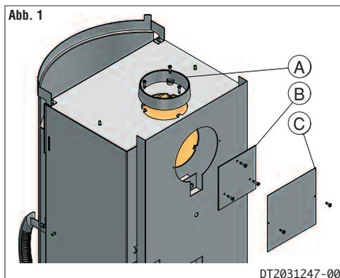
**!** Bei hinterem Anschluss, wird das Blech (C) nicht mehr benötigt.
