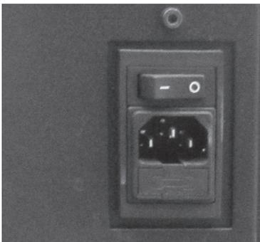
**Elektrische Sicherheit:** der Ofen ist gegen starke Spannungsschwankungen (zum Beispiel Überspannung) durch eine Feinsicherung von 4 A geschützt, die sich im Kaltgerätestecker auf der Rückseite des Ofens befindet. Weitere Sicherungen für den Schutz der Platine sind ebenfalls vorhanden.
